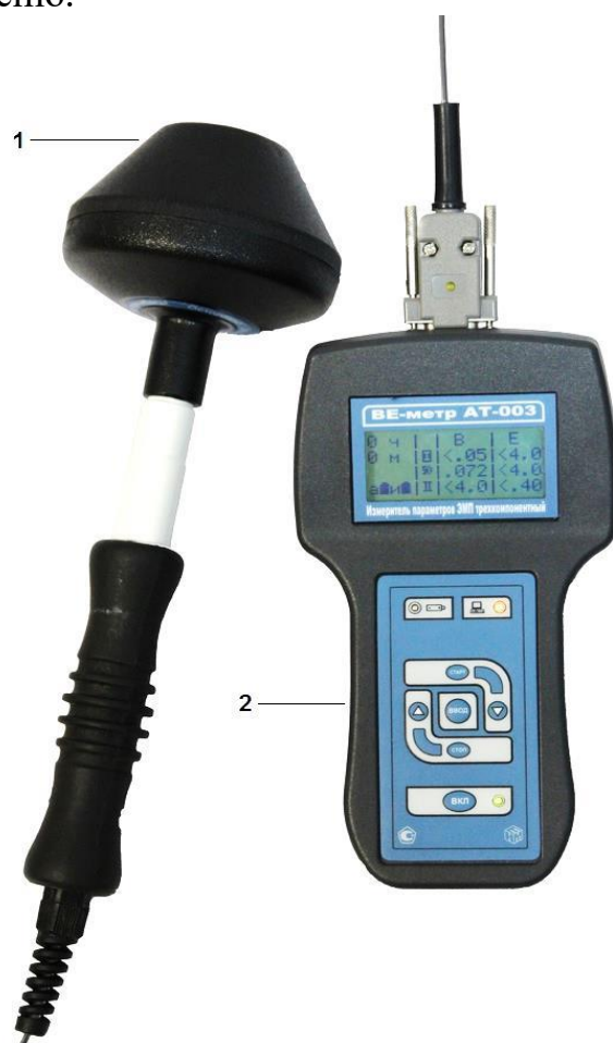
Рис. 7.2. Внешний вид измерительного прибора VE-метр-АТ-003 1 – антенный блок, 2 – блок индикации
